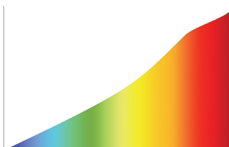
Glühlampe – Mangel an kürzeren Längenwellen im blauen Spektrum
